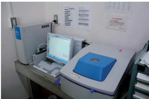
硫黄、塩素測定用のエネルギー分散型
