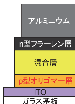
図2 有機太陽電池の構造模式図。
