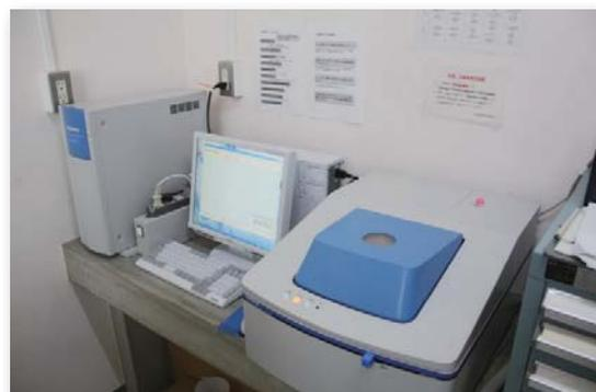
硫黄、塩素測定用のエネルギー分散型蛍光X線分析装置
