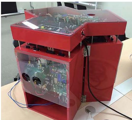
図4 3ポート絶縁型 DC/DC 変換器の外観
