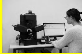
ナノメートルオーダーの高精度な画像解析が可能な分光光電子顕微鏡
