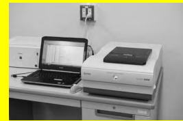
コロイド粒子のゼータ電位および粒子径・粒度分布測定が可能
