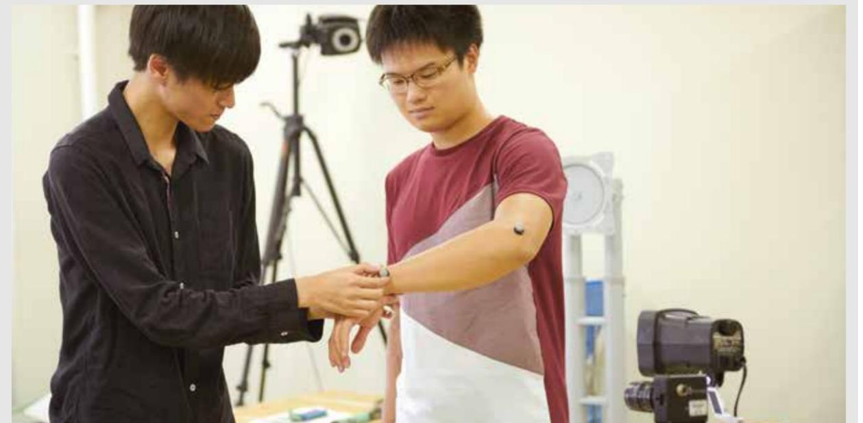
Fig.2——モーションキャプチャのためのマーカーを装着
