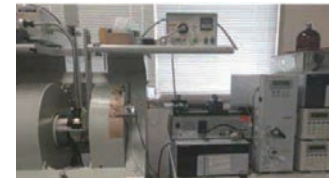
▶研究室で開発した HPLC-ESR 装置 酢の成分を分離し、各成分の抗酸化活性を評価
