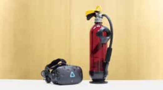
センサー付き消火器と PC 一体型ヘッドマウントディスプレイ (HTC Vive)
