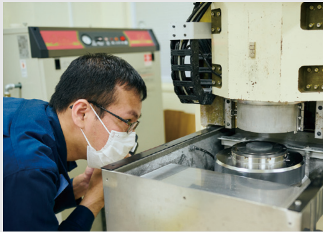
Fig.3——SiCやダイヤモンドなどの鏡面研磨の様子
