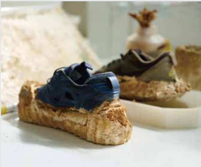
Fig.3——指導学生によるキノコの菌糸体で靴底を修繕する試み
