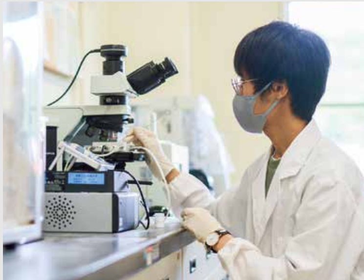
Fig.2——偏光顕微鏡による液晶の観察
