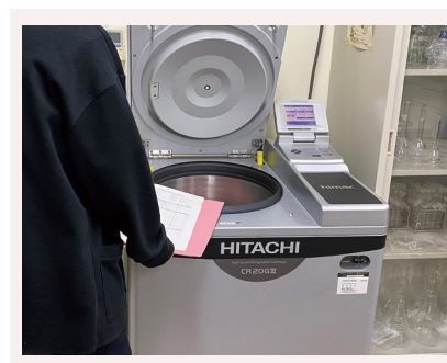
〔Fig.5-1-3〕 動力遠心機械（遠心分離機）の自主点検
