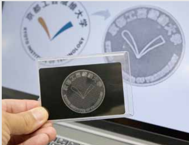
Fig.3——MEW技術を用いることで、大学ロゴも印刷可能
