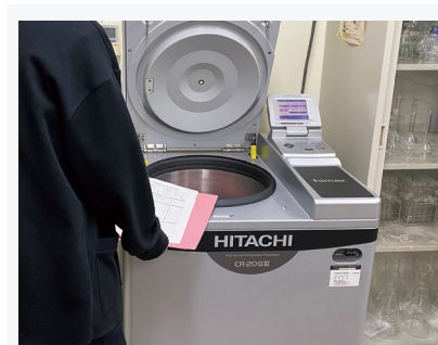
[Fig.5-1-2] 動力遠心機械（遠心分離機）の自主点検
