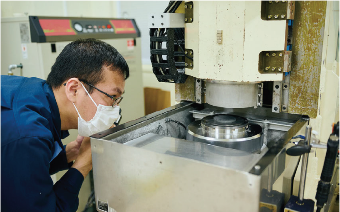
SICやダイヤモンドなどの鏡面研磨の様子
